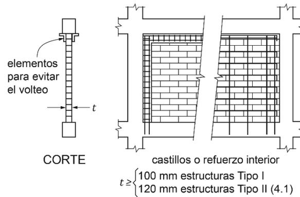
**Figura 0.1** Ejemplos esquemáticos de detallado de muros diafragma
