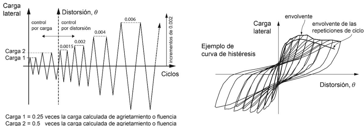
**Figura 0.1 Historia de carga y curva carga lateral–distorsión**
