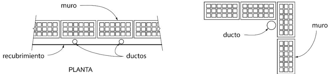
Figura 0.2 Ejemplos de ductos fuera del muro
