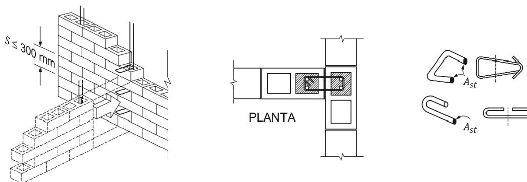
Figura 0.2 Conectores entre muros sin traslape de piezas
