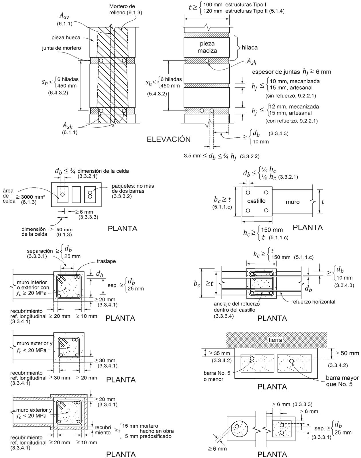
Figura 0.1 Tamaño, colocación y protección del refuerzo
