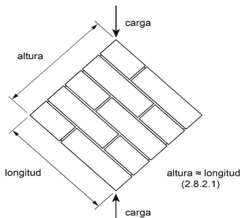
**Figura 0.2 Murete para prueba en compresión diagonal**
