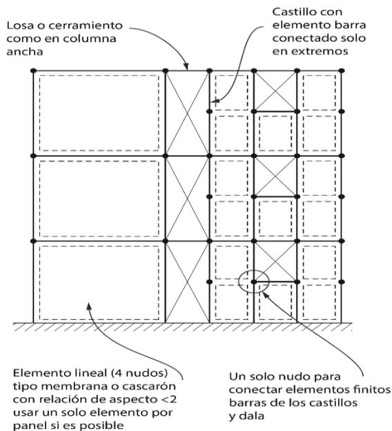
**Figura 0.1** Modelo de muro con elementos finitos
