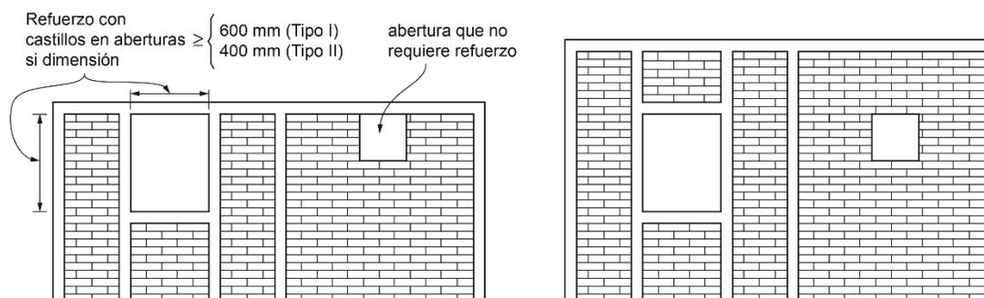
**Figura 0.3 Refuerzo en el perímetro de aberturas**
