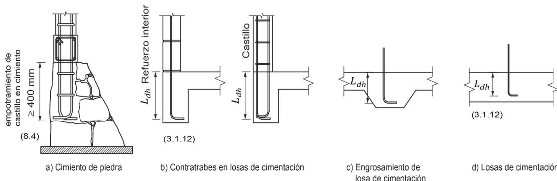
**Figura 0.1 Anclaje del refuerzo vertical en cimientos**
