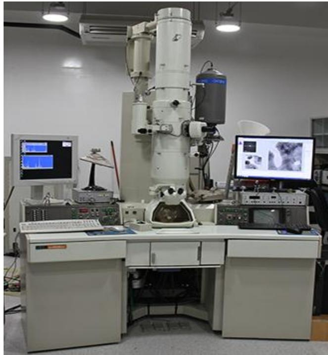
Microscopio electrónico de Barrido
